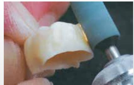
通常のダイヤモンドバーによる研削。赤い発熱が見られる。ジルカット ダイヤモンドバーは高い放熱性により、このような発熱は見られない。
